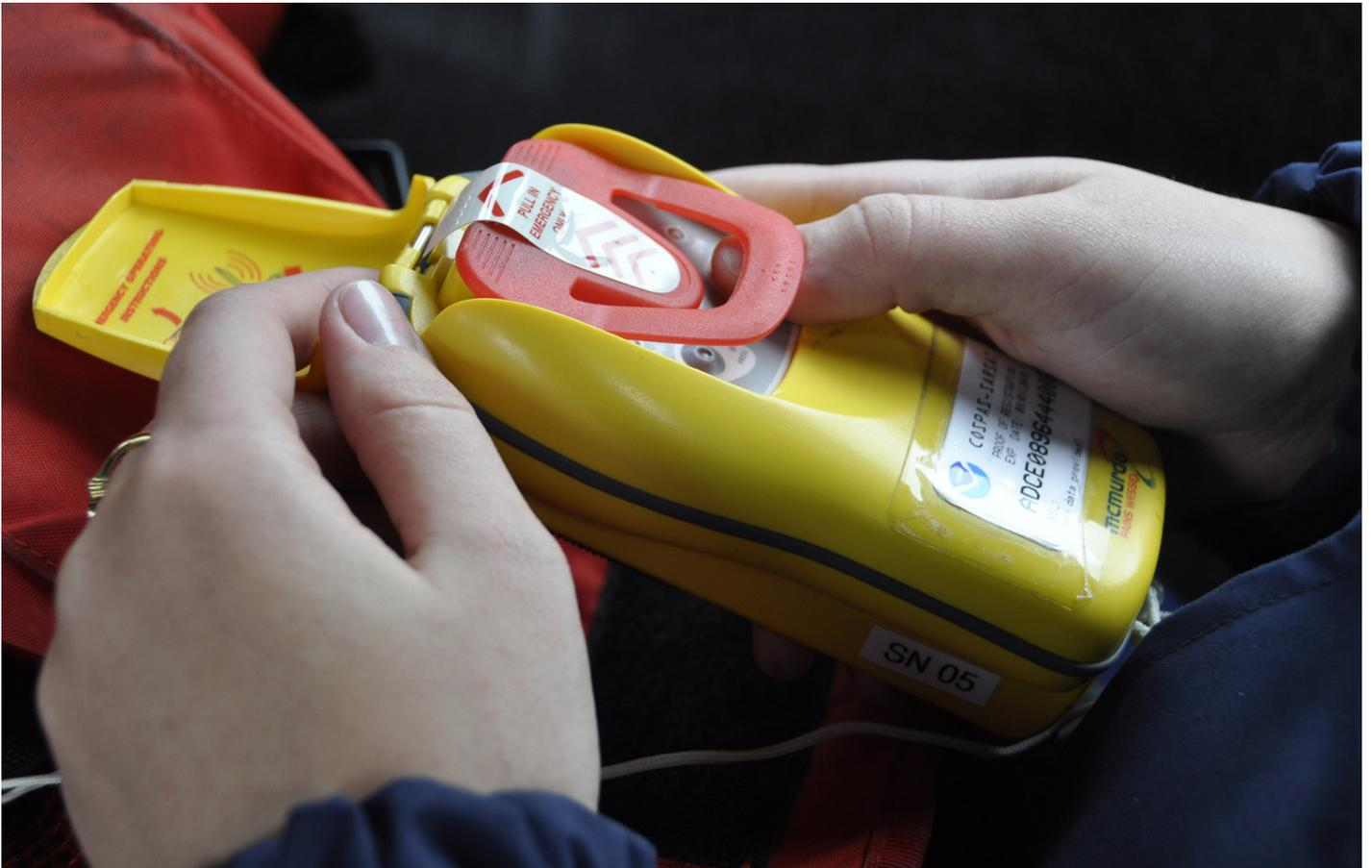
Eine **PLB** ist eine Notfunkbake, mit deren Hilfe die Rettungsdienste eine Person an Land oder auf dem Meer orten können. Wenn sie aktiviert ist, überträgt die PLB eine codierte Nachricht auf der Notfrequenz 406 MHz, die über das Satellitennetzwerk COSPAS-SARSAT<sup>2</sup> überwacht wird. Diese Nachricht wird dann über eine Bodenstation zur nächsten Rettungsleitstelle weitergeleitet, die die lokalen Rettungsdienste aktiviert.
