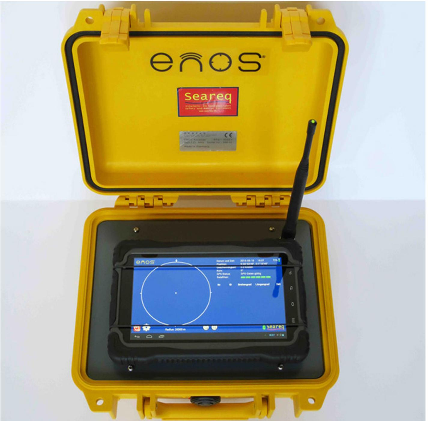
ENOS<sup>3</sup> ist ein relativ bekanntes System, das von Seareq entwickelt wurde, einem deutschen Unternehmen, das Sicherheits- und Rettungsausrüstungen herstellt. Es nutzt zwar weder die Frequenz 466 MHz, noch die AIS- Technologie, folgt aber einem ähnlichen Prinzip. Das ENOS<sup>®</sup>-System ist nicht auf die Hilfe von Rettungseinrichtungen und -diensten angewiesen. Es besteht aus zwei Einheiten, einem Empfänger (an Bord des Tauchboots) und einem oder mehreren Sendern (bei den Tauchern).
